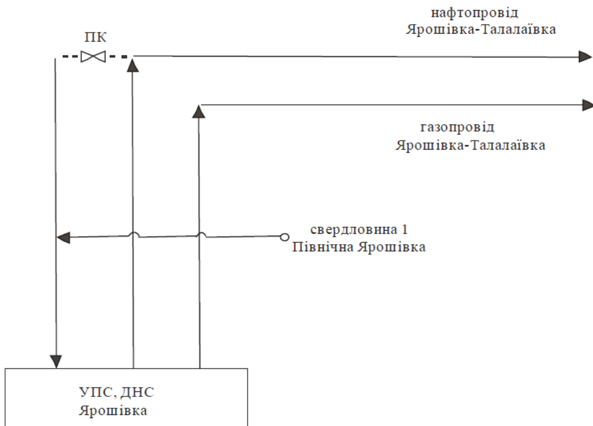
Малюнок 1.4.1 Принципова схема збору та транспортування продукції свердловини Північно-Ярошівського родовища.
